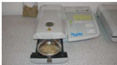
Vandmålingsapparat til måling af vandindhold i græsfrø.
